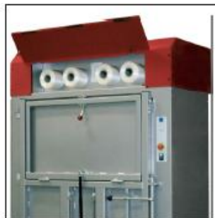
Bandmagasinet är lätt åtkomligt framifrån. Varje band kan bytas enskilt.
