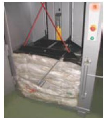
Vid indikering av färdig bal, öppna dörren och banda balen.
