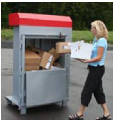
Låg inkasthöjd och en rejäl ifyllnads-volym. Stäng luckan för automatisk pressning.
